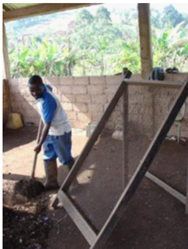
Figure 6 : tamissage manuel avec plan incliné (Dschang)
