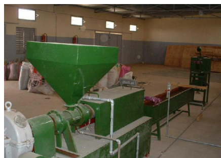
Illustration 2: Ligne d'extrusion d'un capacité d'une tonne/jour
