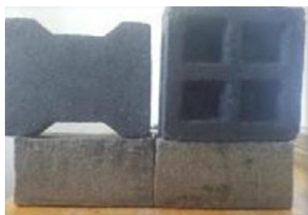
Illustration 3: Pavés et briques de mélange sable-plastique
